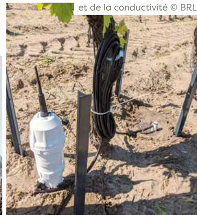
Sonde de suivi de l'humidité et de la conductivité © BRLE
